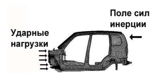
Рассчитывается распределение инерционных сил, уравновешивающих ударные нагрузки, приложенные к салону автомобиля.
